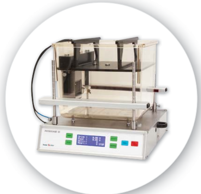
ホームケージとエアータイト式フタ 行動量測定プラットフォームとIRセンサー
